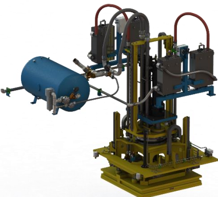
Geteilte Versorgung von Katalysator und Spülluft (patentiert)
